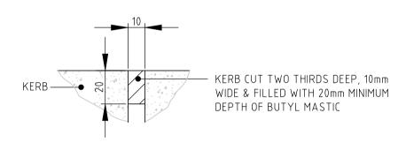
KERB EXPANSION JOINT DETAIL N.T.S.
