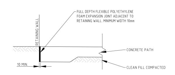
EXPANSION JOINT DETAIL — RETAINING WALL/PATH
