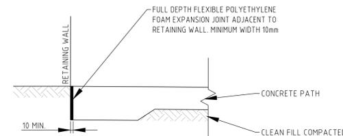
**EXPANSION JOINT DETAIL – RETAINING WALL/PATH**
